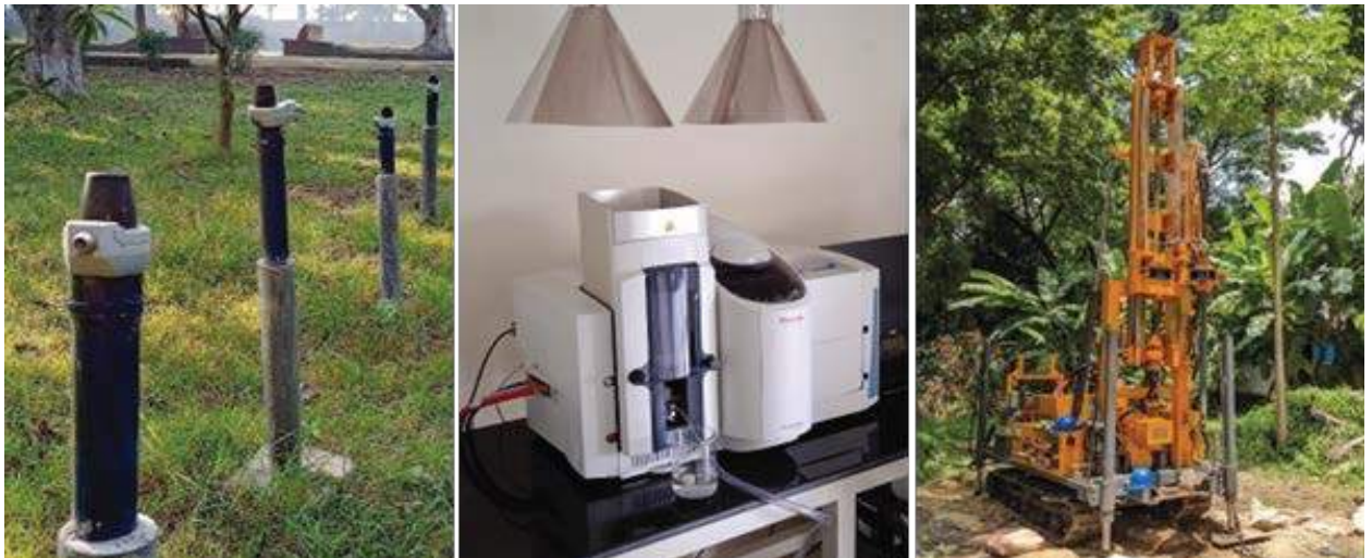
ছবি ১: (বাম দিক হতে) বাংলাদেশের বিভিন্ন স্থানে ৯০টি অটোমেটেডকৃত পর্যবেক্ষণকূপের ১টি গুচ্ছকূপ; পানির গুণাগুণ পরিমাপের জন্য ল্যাবরেটরীতে স্থাপিত এটমিক এবসরপশন স্পেকট্রোফটোমিটার; বিভিন্ন অবকাঠামোর নকশা প্রনয়নের লক্ষ্যে ভূ-কারিগরী অনুসন্ধানের জন্য সংগৃহীত ড্রিলিং রিগ।
